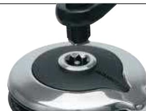
Wird eine Harken Kurbel mit Sicherung in die unbelastete Winsch eingesetzt, wird automatisch der Antrieb abgekoppelt für manuellen Betrieb.
